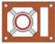
Bild 2: Überdruckabgasleitung BÜ+i, einzügig mit Installationsschacht
