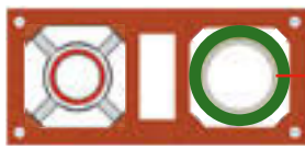
Bild 4: Überdruckabgasleitung CI/BÜ+i, zweizügig kombiniert mit Leistungsschornstein und Installationsschacht
