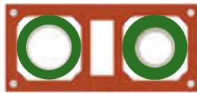
Bild 4: Erlus Leistungsschornstein CIE, zweizügig mit Installationsschacht (beide Züge Leistungsschornstein CI)
