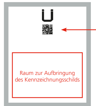
Bild 1: Innenseite des Mantelsteinverschlusses der unteren Putztüre
